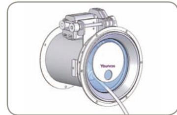
Sollte das Elektrofahrzeug aus Unachtsamkeit trotz bestehender Steckverbindung von der Ladestation entfernt werden, wird der Stecker über die integrierte Rutschkupplung abgezogen. So werden Beschädigungen an Fahrzeug und Ladestation verhindert. Wenn die Klappe gewaltsam geöffnet wird greift ebenfalls die Rutschkupplung des Systems, um Schäden an der Mechanik zu vermeiden. Zum Schutz der elektronischen Komponenten wird die manuell geöffnete Klappe über die Positionserfassung wieder geschlossen.
